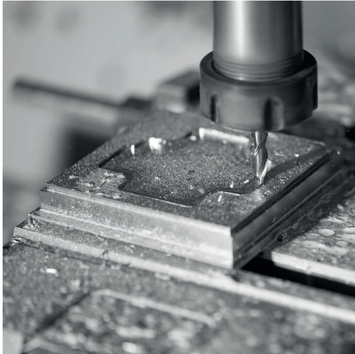
Lavorazione meccanica dal pieno di alluminio Milling machine from aluminium billet
